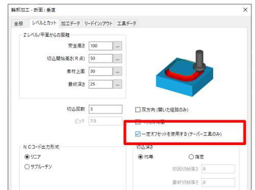
このオプションにより、テーパ工具でのテーパ面輪郭加工時の工具経路は下図右のように作成できます。
